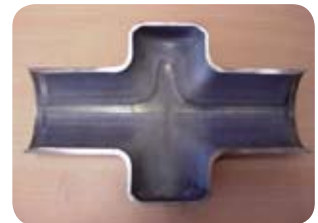
Deformación de la soldadura 1.4003.
