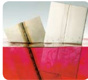
Antes y después del decapado
