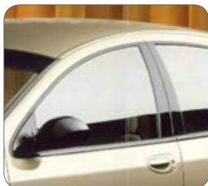
Tipo 1.4016/430, guarnición revestida en negro, EE.UU.
