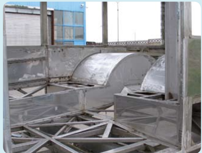
Basidor estructural soldado, tipo 1.4003.
