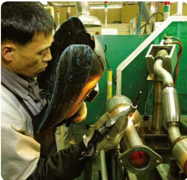
Soldadura de sistema de escape, tipo 439, Corea del Sur
