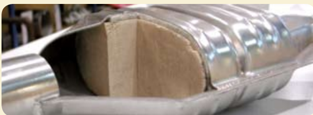
Carcasa estampada de convertidor catalítico, tipo 441
