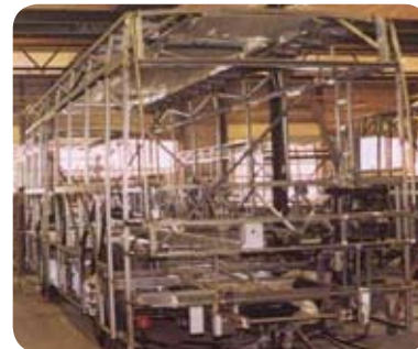
Bastidor de carrocería de autobús, tipo 410, Sudáfrica.
