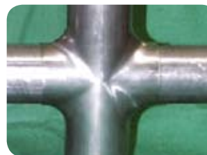
Tubo soldado hidroconformado 1.4003.
