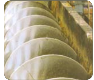
Tipo 1.4003/410, Columbus, Sudáfrica. En este caso, el acero ferrítico ha tenido una duración superior a 18 años...
